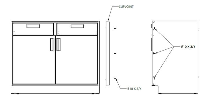
SLIDE FILLER INTO SCRIBE AND AGAINST WALL USING THREE DRYWALL SCREWS ATTACH FILLER TO WALL
