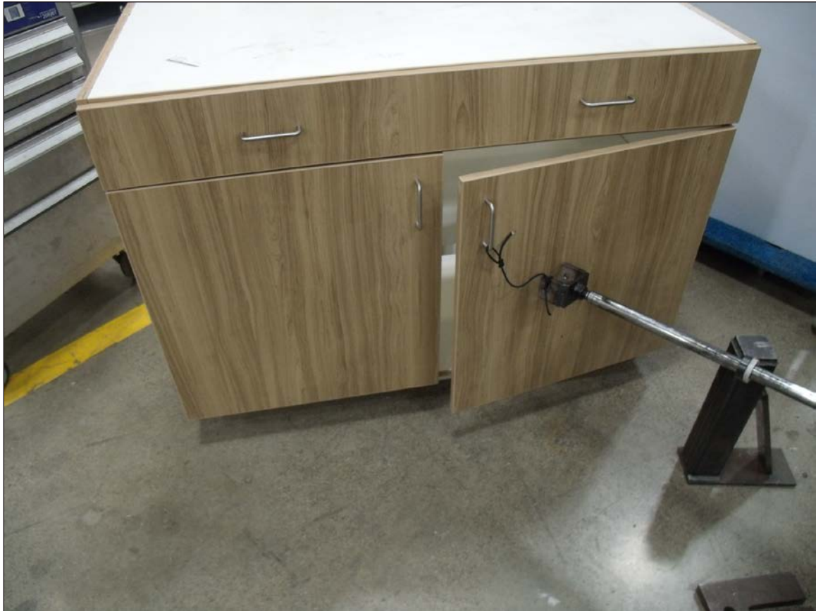
Door Cycle Test
