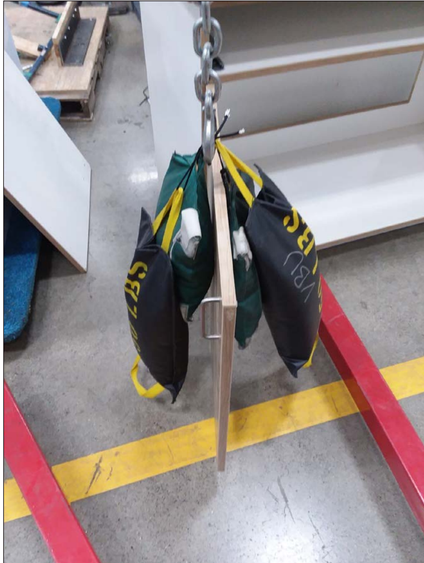
Door Hinge Test
